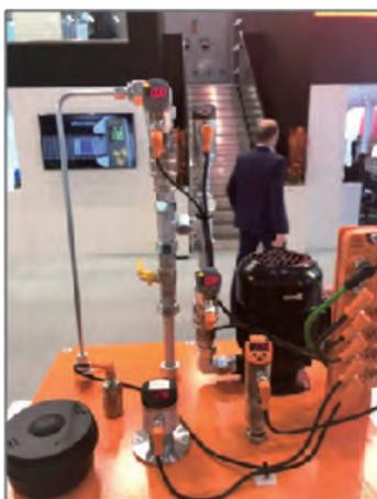
デジタルの圧力・流量計・油量計
