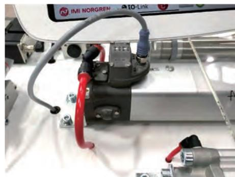
写真 1、2 IMI Precision Engineering 社 (米国) 位置センサ内蔵シリンダ
