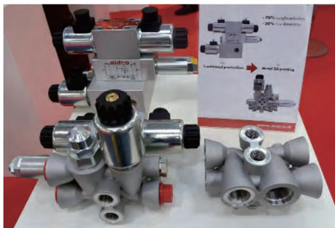
写真奥が従来品、写真手前の 2 台がアディティブ・マニュファクチャリングによる 3D 製品
