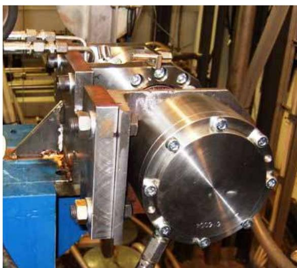
写真 3.3 水圧マニピュレータ
