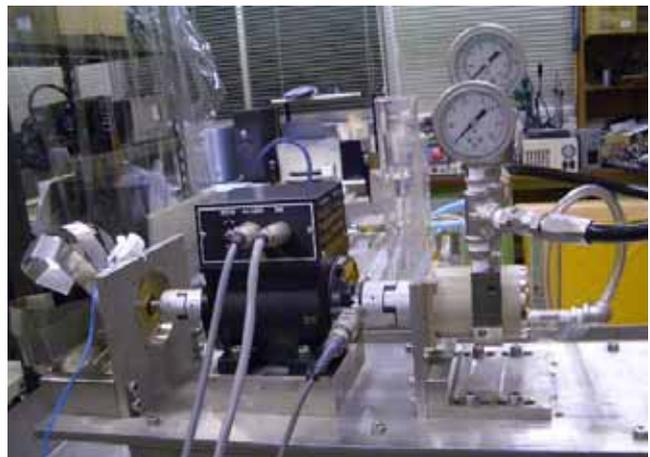
図 1.4.21 ベーンモータの性能試験
