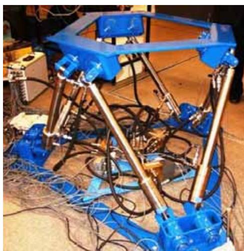
写真 3.2 水圧 6 軸モーションテーブル
