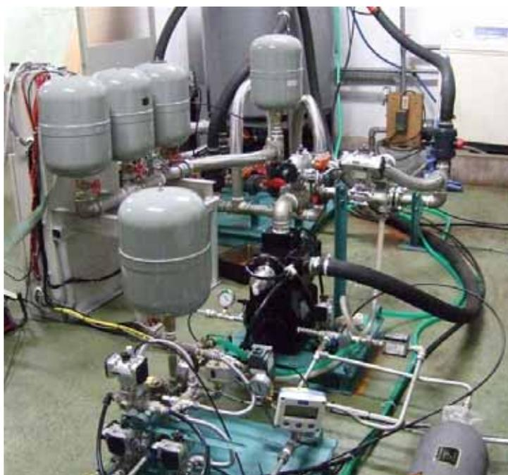
図 1.2.7 増圧装置単体試験写真
