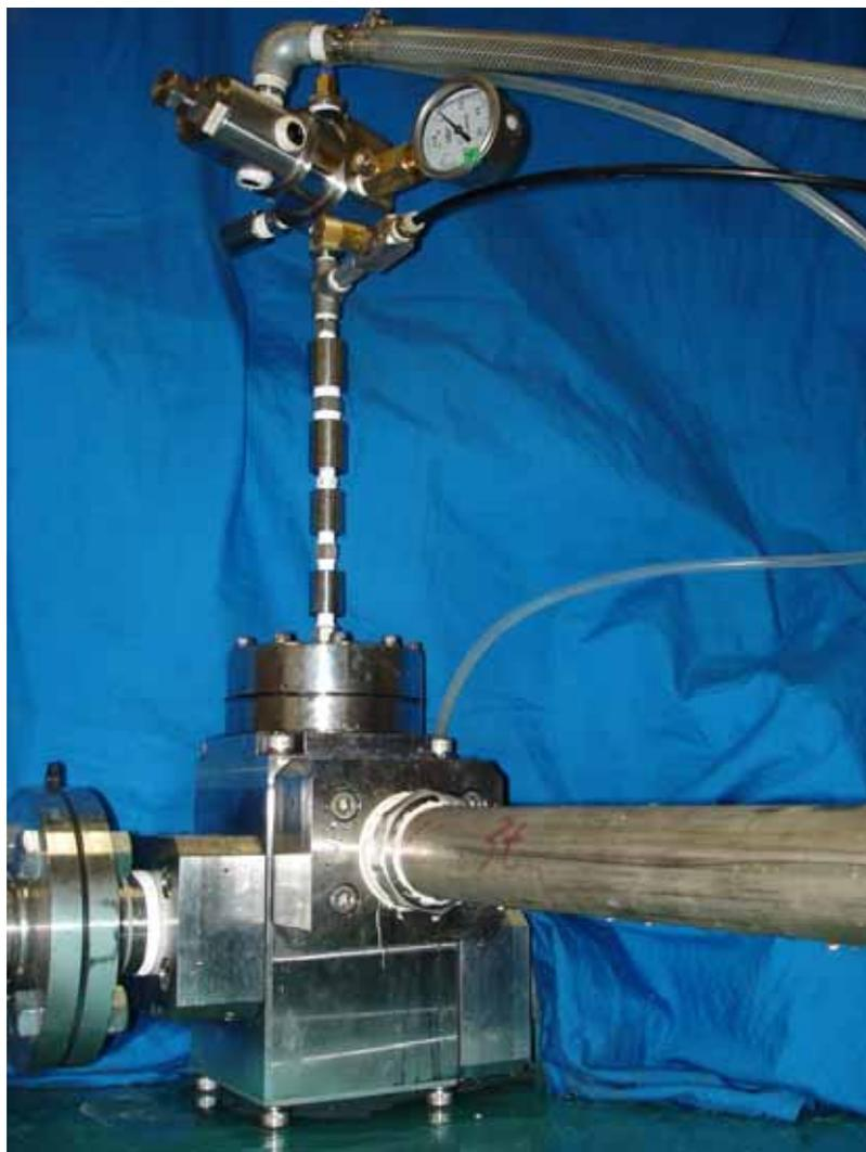
図 1.1.6 試作した 2 段式減圧弁の写真
