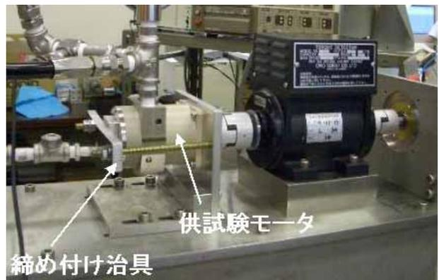
図 3.3.14 ベーンモータの性能試験
