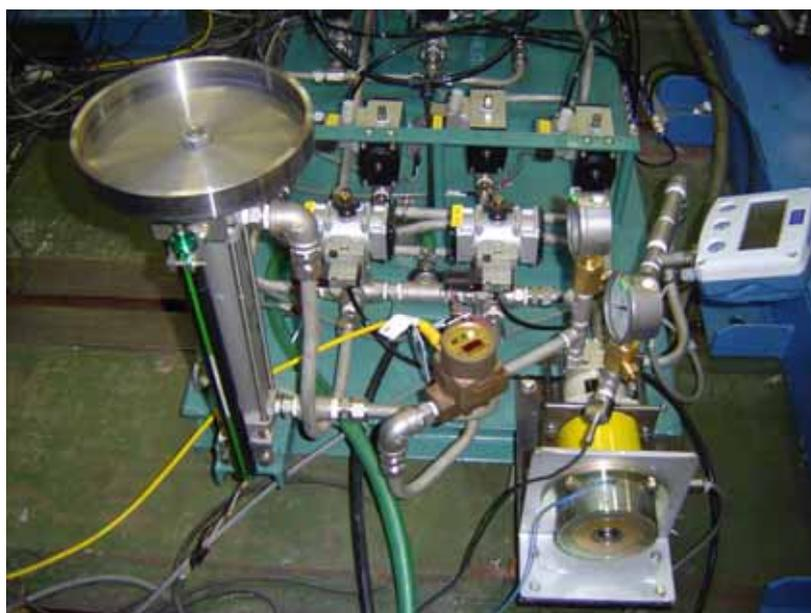
図 1.3.2 エネルギー有効利用装置アクチュエータ外観図
