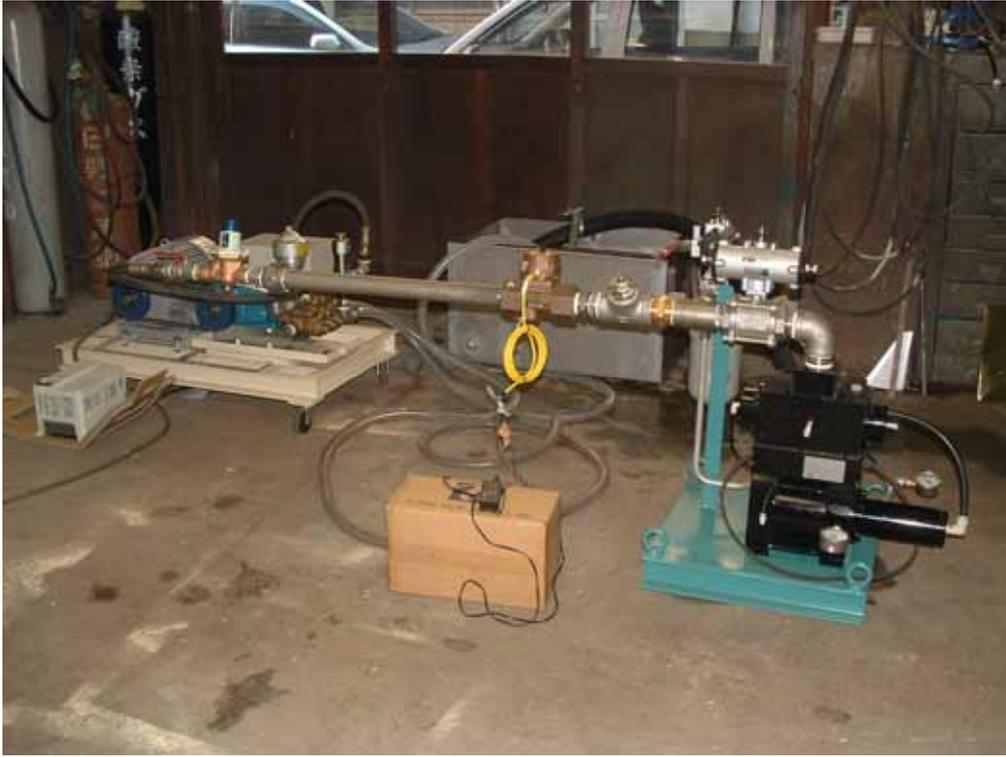
図 1.2.6 ( 1 ) 増圧器単体試験装置概観
