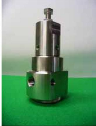
図 1.1.5 試作したパイロット弁の写真
