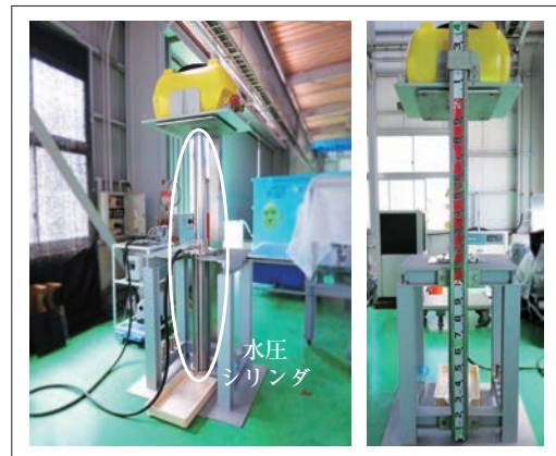
図 3.2.4 水圧シリンダの試験装置
