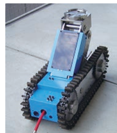
図 3.4.6 水圧ジャッキアップロボット
