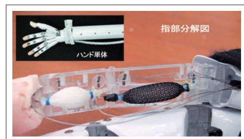
図 3.3.7 ロボットハンドと指部
