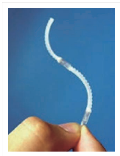
図 3.3.1 水圧駆動方式能動カテーテル
