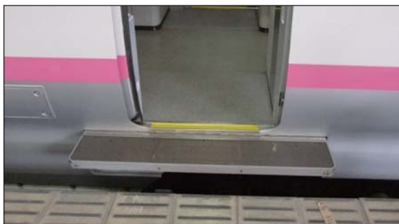
図9.3 新幹線駅で開いたステップ装置
