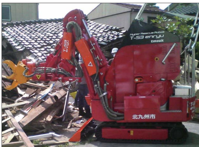
図19.1 油圧レスキュー双腕ロボット『援竜』
