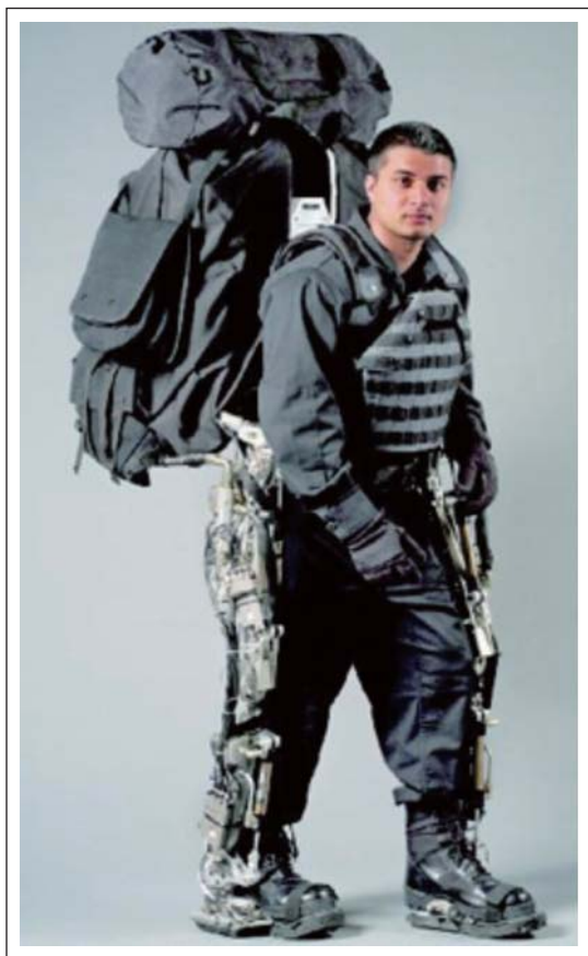
図19.2 油圧パワーアシスト装置BLEEX
