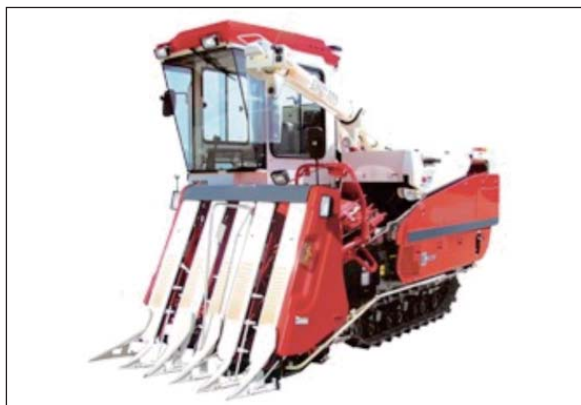
図4.4 自脱形コンバイン
