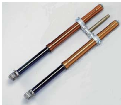
図3.1 モトクロスレース用フロントフォーク
