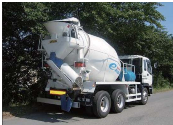
図5.1 コンクリートミキサ車
