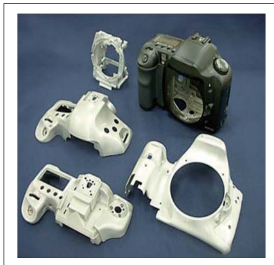
図15.2 一眼レフカメラの外装部品
