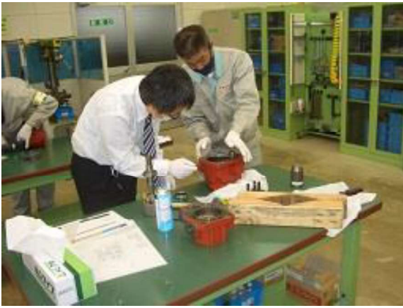
斜板ポンプ分解状況
